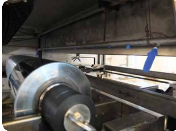
Sprüharm und Bürsten im Reinigungsraum
